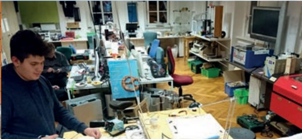
Hier im Werkstatttraum stehen sie für alle Interessierten zur Verfügung: die 3D-Drucker und Lasercutter, die 3-Achs-Fräse, die Thermotransferpresse für den T-Shirt-Druck, daneben die computergesteuerte Näh- und Stickmaschine sowie die notwendigen Arbeitsplatztische mit PC und Material für die Robotertechnik und vieles mehr. Grundlage ist die entsprechende Software – für jeden zugänglich als „Open Source“.
