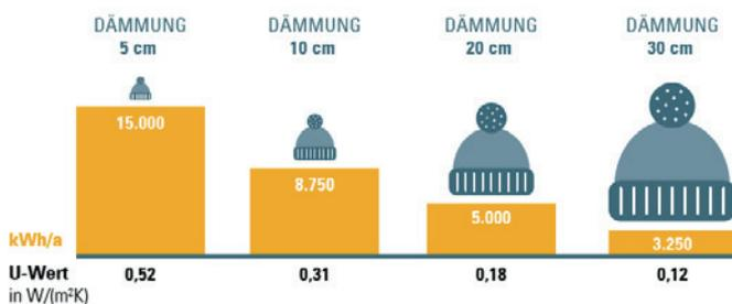
Typische Wärmeverluste in Kilowattstunden pro Jahr (kWh/a) über die Außenwand eines Einfamilienhauses mit 24 cm starken Hochlochziegeln und verschieden dickem Dämmstoff (Wärmeleitfähigkeit 0,04 W/(mK)). Für einen U-Wert von 0,15 (W/m²K) sind etwa 25 cm Dämmung notwendig. Quelle: LfU (2021): In der Zukunft zu Hause: Hocheffizient bauen und sanieren
